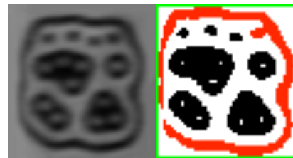
Fig. 1 (gauche) Image de symbole avec du « motion blur » horizontal. (droite) Reconnaissance de la position et du contour du symbole malgré la segmentation imparfaite. Le symbole ainsi altéré ne peut toutefois pas être décodé.
